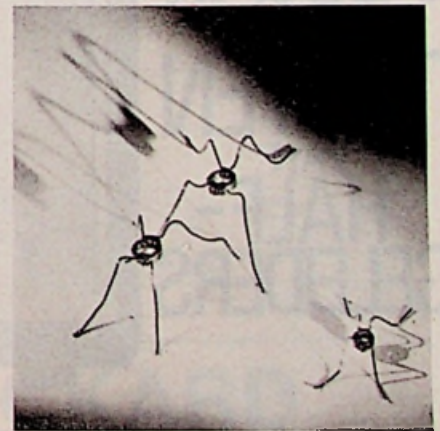
Ringkernen voor brede band- en impulsopsluggingen van Siemens. Siferrite met aanvangspermeabiliteit tot 10 000, curietemp. hoger dan 130°C, verliesfactor bij 20 kHz kleiner dan 2 \cdot 10^{-6} en bij 100 kHz kleiner dan 12 \cdot 10^{-6}
